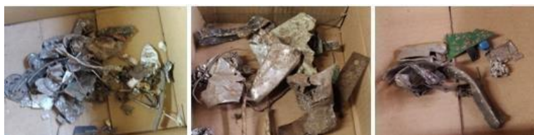
Figura 7: Terra de Shredder peneirada, frações retidas nas peneiras de 2,0mm a 0,075mm.
