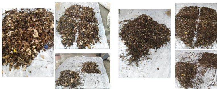
Figura 2: Homogeneização e quarteamento do Fluff e Terra
